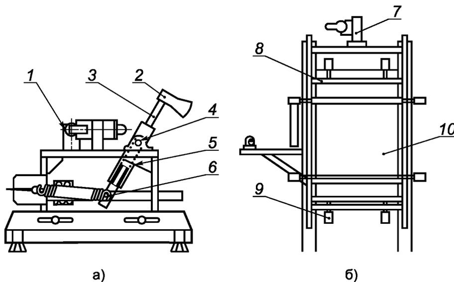
1 — высвобождающий механизм; 2 — головка топора; 3 — рукоятка; 4 — ось вращения; 5 — зажимное приспособление; 6 — натяжная пружина; 7 — регулятор высоты; 8 — зажимная рама; 9 — пневматические зажимы; 10 — испытываемый образец
