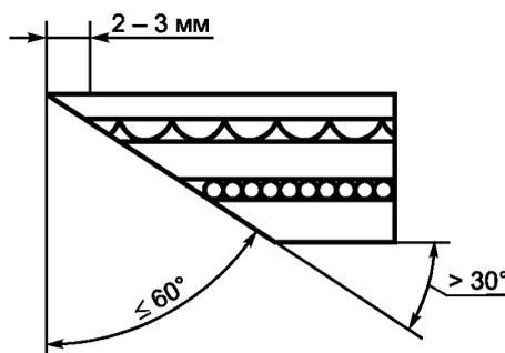
Рисунок А.7 — Обработанный фацетированный край
